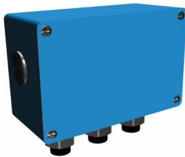
Boîte à bornes auxiliaire en aluminium, petite pour les hauteurs d'axe 280-450 (codes option 418, 568, 380, 569). La taille de la boîte à bornes commandée avec ces codes dépend du nombre d'accessoires commandés. 80 x 125 mm, pour 12 fils maxi. Mise à la terre M4
