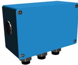
Boîte à bornes auxiliaire en aluminium, petite pour les hauteurs d'axe 280-450 (codes option 418, 568, 380, 569). La taille de la boîte à bornes commandée avec ces codes dépend du nombre d'accessoires commandés. 80 x 125 mm, pour 12 fils maxi. Mise à la terre M4
