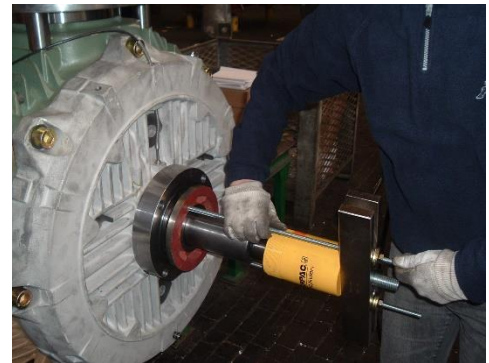
Extracción de juntas con extractor
