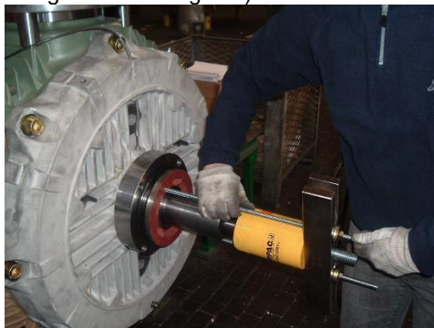
Extracción de juntas con extractor
