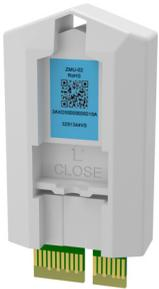
Die Memory Unit definiert die Identität und Funktionen des Antriebs. Auf ihr sind die Firmware und die gespeicherten Parameter des Antriebs abgelegt. Die Memory Unit enthält das Mint-Programm für programmierbare Modelle. Die Memory Unit ist eine wesentliche Komponente des Antriebs und muss stets eingebaut sein. Sie ist nicht darauf ausgelegt, häufig aus- und eingebaut zu werden.
