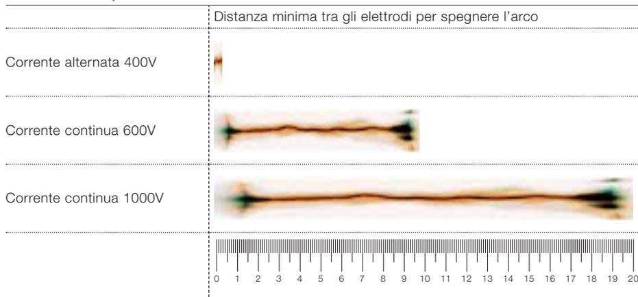
Un arco elettrico si può innescare tra due elettrodi a causa della tensione presente ai loro capi.
