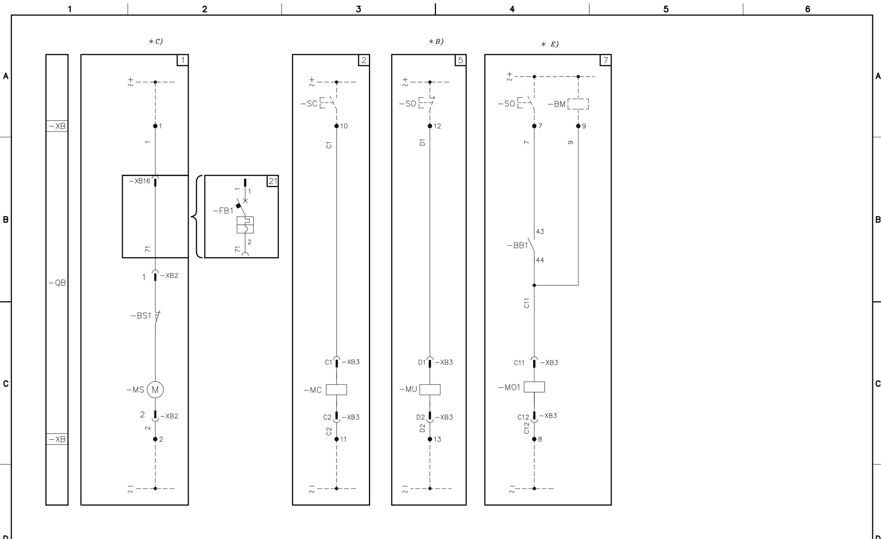
CIRCUIT DIAGRAM OF VD4/R VD4/UNIAIR-F VD4/UNIMIX-F -R
