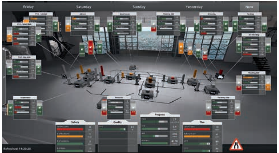
1 El prototipo ofrece un panorama completo del estado de la producción. La información presentada puede filtrarse por criterios como seguridad, calidad, etc.
