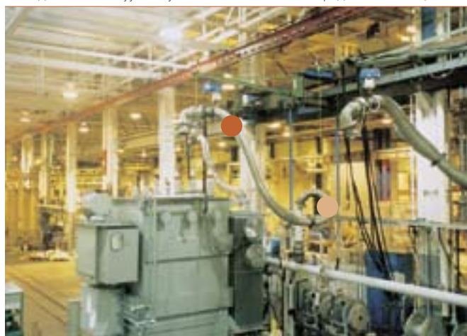
3 Установка LFH для сушки небольшого силового трансформатора с использованием его собственной оболочки
