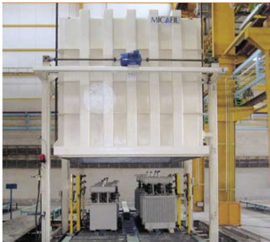
2 Конусный автоклав с системой нагрева токами низкой частоты для обработки распределительных трансформаторов
