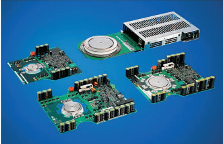
Cette aptitude unique en fait le composant idéal pour convertir la forme de l'onde de courant et de tension (alternatif en continu et vice versa) et faire varier la fréquence.
