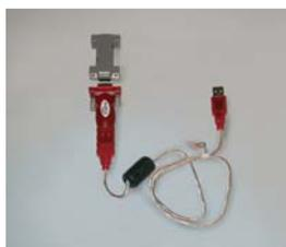
Câble qui permet de connecter l'ordinateur PC à la porte RS485 prévue dans le compartiment de basse tension du panneau pour configurer l'eVM1.
