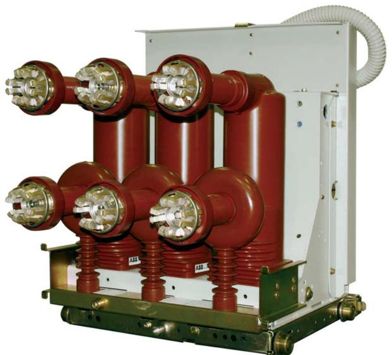
Les disjoncteurs eVM1 sont équipés de capteurs de courant sur les bornes du pôle et le circuit secondaire est raccordé directement sur le module de contrôle et de protection embarqué sur le disjoncteur. Un seul type de capteur couvre toute la gamme des courants nominaux.
